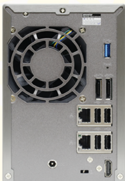
↑ 雙GbE網路埠、HDMI、USB 2.0/3.0、eSATA皆一應俱全；70mm抽風扇則常保硬碟涼爽健康。
