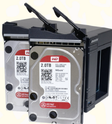
↑ 本次以兩顆2TB紅標硬碟，構成Raid 0進行測試。
