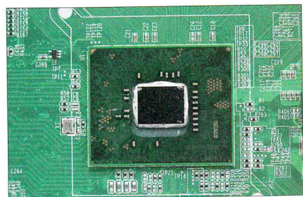
Intel Atom CE5335為嵌入式SoC解決方案，主機板上晶片數量並不多。
